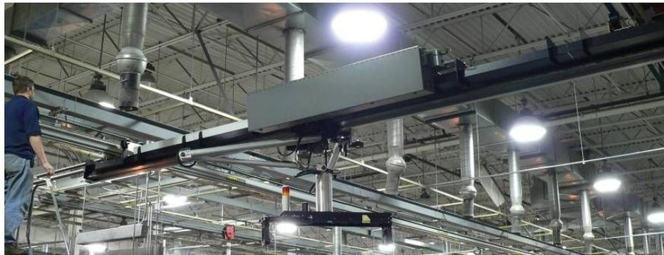
**CAMotion 社は、天井ガントリと主制御盤の間で安全関連データと通常の制御データの両方を通信する手段としてワイヤレス対応の Profinet を使用している**
